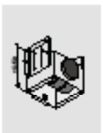
Enkel installasjon ved montering på platen fra utskjæringen på det nedsenkete taket
