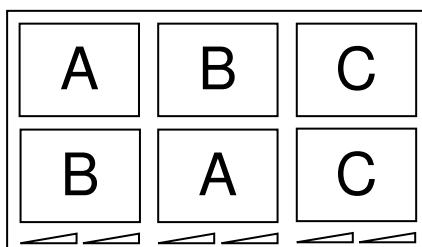
Hvis det valgte varmetrin for begge zoner overstiger maks. ydelse, reducerer power management funktionen automatisk ydelsen på en af disse zoner. Displayet til denne zone blinker først, og varmetrinnet reduceres herefter til højest mulige varmetrin.
