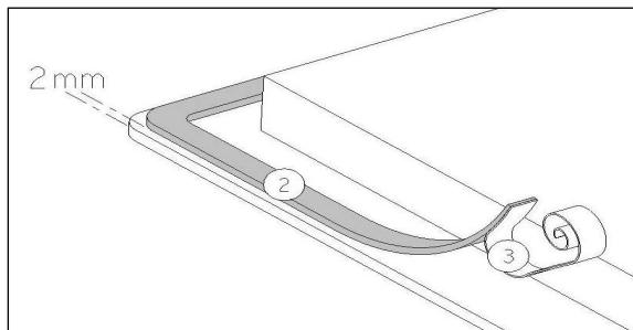
Fäst tätningslisten (2) två millimeter från glasetts ytterkant, efter att Du avlägsnat det skyddande pappershöjlet (3).
