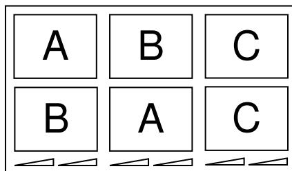
Om det valda effektläget för båda zonerna överstiga max. effekt minskar power management funktionen automatiskt effektläget för en av dessa zoner. Displayen för denna zon blinkar först och effektläget minskas sedan till det högst möjliga effektläget.
