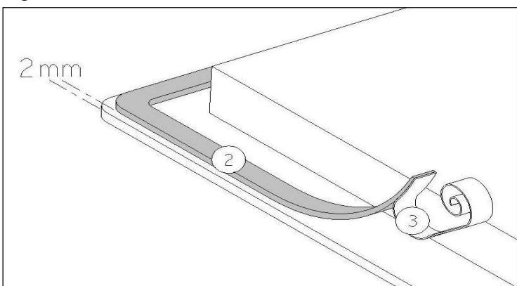
Fastgør tætningslisten (2) to millimeter fra glassets yderkant – efter De har fjernet den beskyttende papiroverflade (3)
