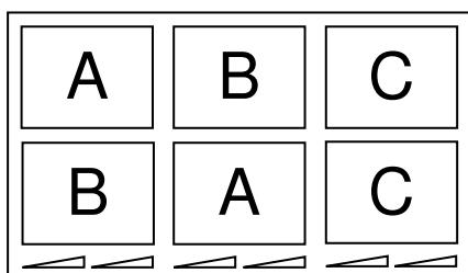
Hvis det valgte varmetrinn for begge soner overstiger maks. Ytelse, reduserer power management-funksjonen automatisk ytelsen på en av disse sonene. Displayet til denne sonen blinker først, og varmetrinnet reduseres så til høyeste mulige varmetrinn.
