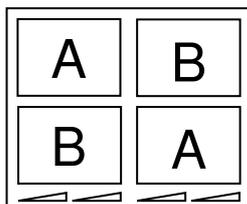
Hvis det valgte varmetrin for begge zoner overstiger maks. ydelse, reducerer power management funktionen automatisk ydelsen på en af disse zoner. Displayet til denne zone blinker først, og varmetrinnet reduceres herefter til højest mulige varmetrin.
