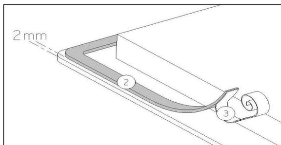
Fäst tätningslisten (2) två millimeter från glasets ytterkant, efter att Du avlägsnat det skyddande pappershöljet (3).
