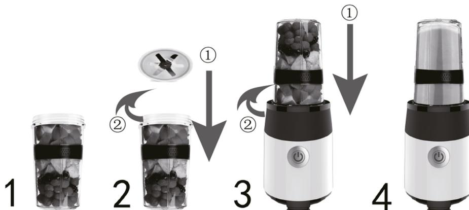
**REMARQUE : Le mixeur ne fonctionne que si l'unité de pulvérisation et le bol mixeur sont montés correctement sur le bloc moteur.**
