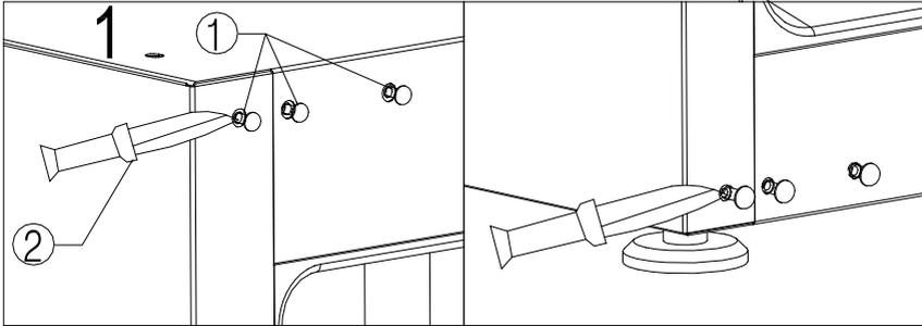
3. À l'aide d'un tournevis cruciforme (4), démontez les vis M5 (3) qui fixent les axes de charnières supérieure et inférieure (figure 2).
